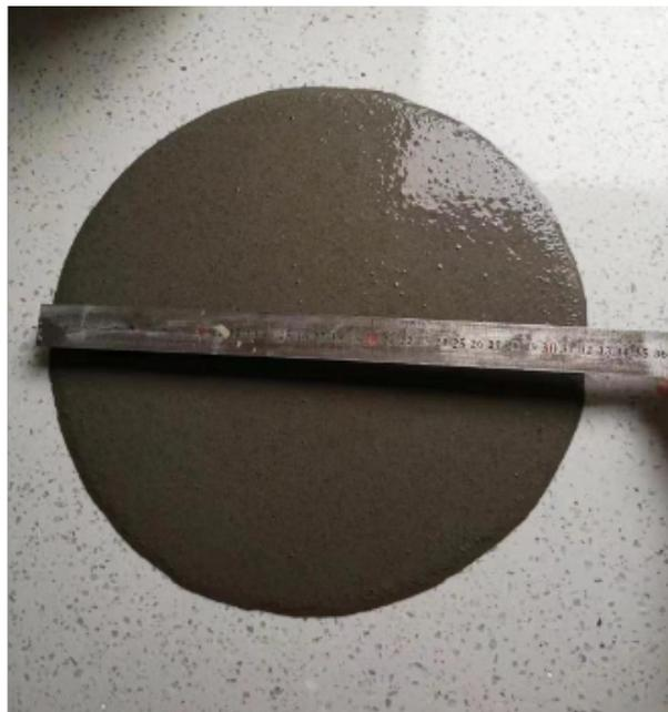
石膏砂浆以半水石膏为基材、高分子聚合物为胶凝材料，经无机填料干混制成。石膏砂浆改变了以水泥基为胶凝材料的传统习惯，方便现场文明施工，是一种新型改良内墙粉刷材料。材料特点及使用建议石膏砂浆具有施工方便、损耗少、空鼓开裂控制效果好、节能环保、可进行薄抹灰施工等优点，且相关质量通病少，可降低后期整改成本。石膏砂浆遇水稳定性差，不适用于厨卫、外墙等潮湿环境与贴砖部位。为避免出现返潮，首层建议不采用石膏砂浆抹灰，广东、广西、海南、福建等地区建议慎重选择使用石膏砂浆。施工建议采用天然抹灰石膏、轻质抹灰石膏、脱硫抹灰石膏，不建议使用重质抹灰石膏（发黄概率高）、磷抹灰石膏（杂质多，放射性元素高）。嘉兴支座砂浆怎么样砂浆添加剂选购，东曜新材料。
